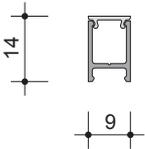
→ Profilo operante con un circuito elettronico dedicato da 14,4W-24V per ml; sezionabile ogni 32mm. 240 LED per ml.
